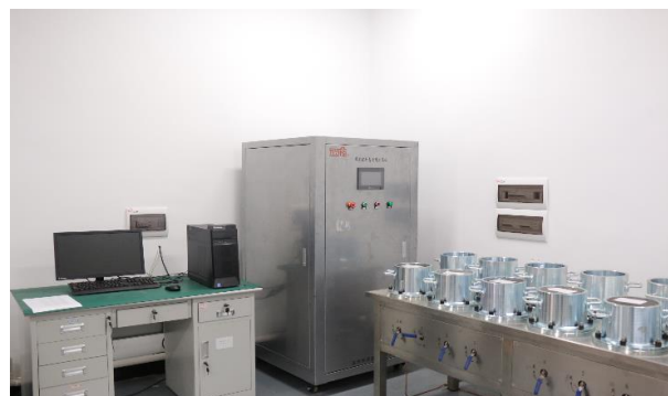
高精度微机控制抗渗仪、抗渗模脱装一体机
