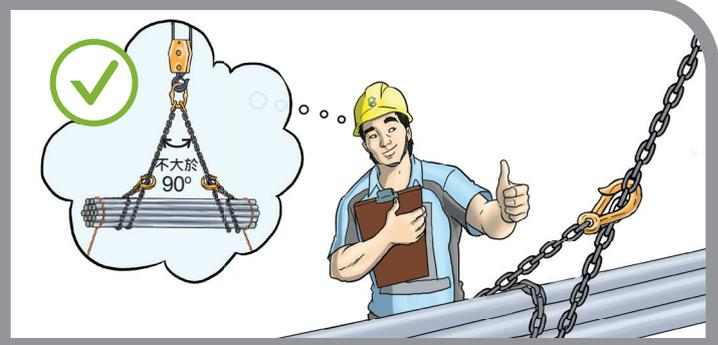
使用複式吊索進行吊運時，必需確保沒有因吊索支腳之間的角度，而引致吊索支腳的負荷超逾其安全操作負荷，並使用足夠強度的鈎環，環圈或鏈環連接吊索支腳的上端。
