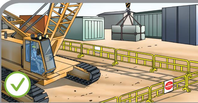
進行吊運工序時，必須確保吊運範圍已妥善圍封及張貼清晰告示，並確保範圍內沒有任何人(吊機操作員除外)。
