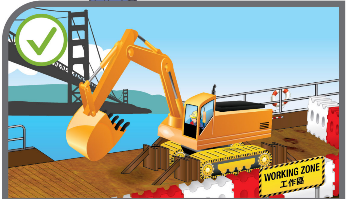
船上的挖掘機及其他的起重裝置須繫穩於固定位置上。
