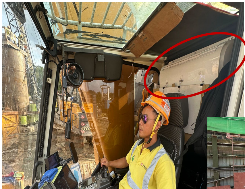
駕駛室內提供空調設施
