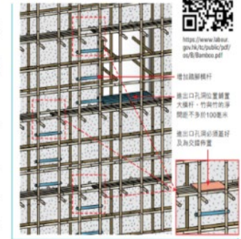
(圖一)竹棚之進出口位置、連繫器及棚架者於孔洞的交錯布置示意圖(轉載自勞工處的《竹棚架工作安全守則》)
