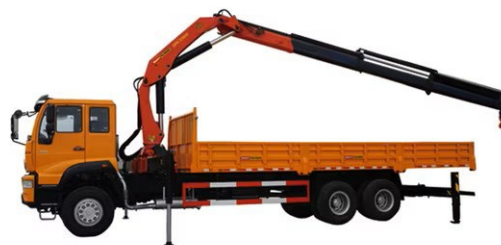
貨車式起重機 (吊機車)
