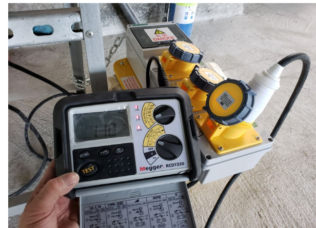
測試電力供應系統
