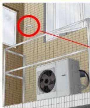
澆注錨固裝置
