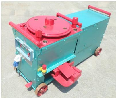
設備 1：HS40 鋼筋剪屈鐵機
