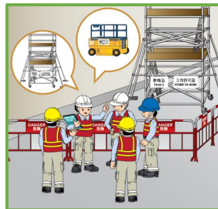
向工人提供及使用合適的工作平台進行高空工作（例如：移動式升降工作平台或金屬棚架）
