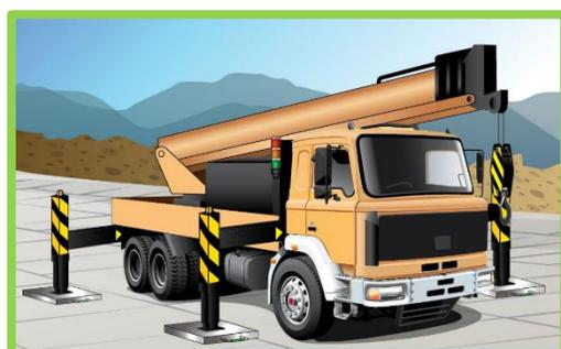
流動起重機設置地點需為穩固的地面並能足夠承托流動起重機及負荷物的重量
