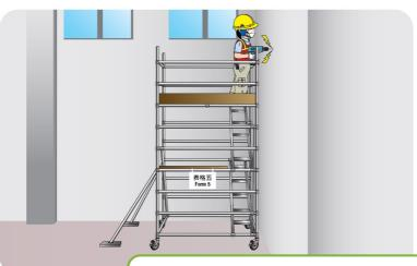
使用合適的支撐腳以防止因橫向力,扭力或撞擊力引致金屬 棚架的過分移動及翻倒情況。
