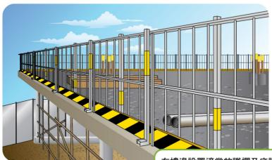
在樓邊設置適當的護欄及底護板。 Provide guard-rails and toe-boards at the floor edge.
