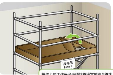
棚架上的工作平台必須設置適當的安全進出口。
