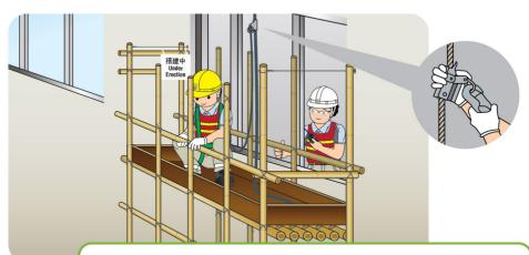
工人在搭建、更改、拆卸棚架、或當設置安全工作平台或提供安全進 出口並不切實可行時,須配戴全身式安全吊帶,並繫於穩固的繫穩點 或獨立救牛繩上。
