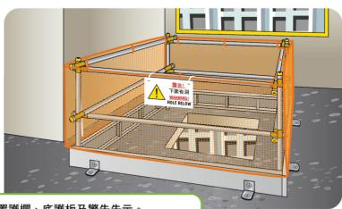
在樓面孔洞設置護欄、底護板及警告告示。
