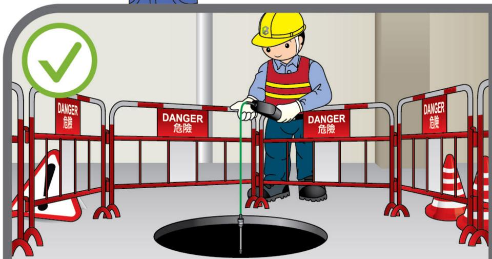
進入密閉空間工作前須進行氣體測試，以確保密閉空間的空氣質素不會對核准工人的安全構成危害。
