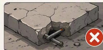
吊運物料損壞或強度不足
