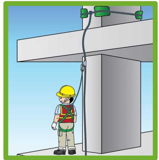
工人拆卸工作台時，必須佩戴全身式安全吊帶，並把懸掛繩繫於穩固的繫穩點或連接到獨立救生繩上的防墮裝置
