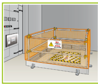
在樓面孔洞設置護欄、底護板及警告告示
