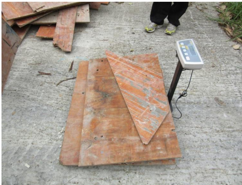
圖 6 秤量建築廢物
