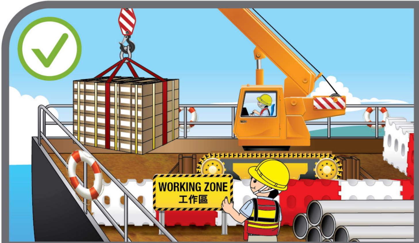
使用起重裝置及起重工具前，須檢查、測試及徹底檢驗。 遠離工作區。
