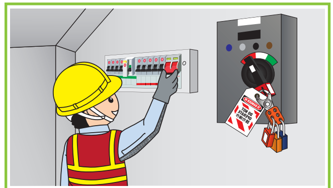
4. 定期檢查電力設備及安裝過荷保護及漏電保護器。
