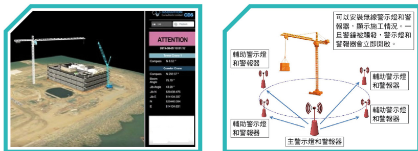
圖5：塔式起重機吊運區中不安全行為 / 危險情況的監測系統
