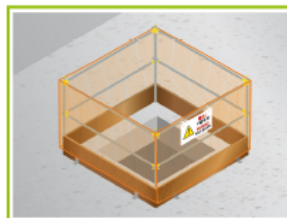
在樓面孔洞設置護欄、底護板及警告告示。
