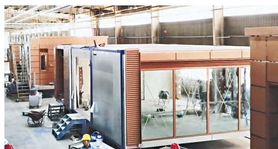
▲MiC建築模式改將大部分工序先在工廠內完成，再運到現場裝嵌，從而縮短施工期，為香港抗疫工作立下大功。
