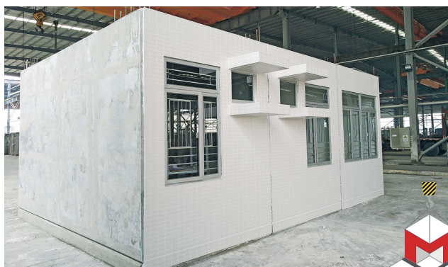
▲MiC項目以「先裝後嵌」方式，於廠房生產獨立預製模組，再運送至工地安裝。
