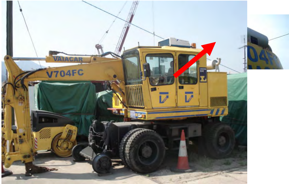
圖 4：安裝 1 部攝影機的挖土機設置
