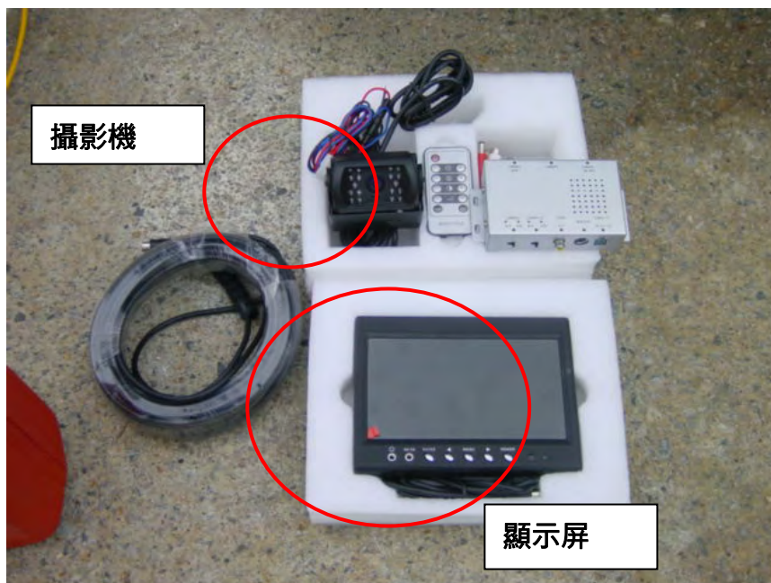
圖 1：典型倒車視像裝置
